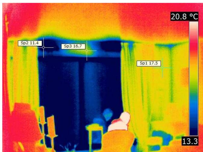
Cette photo prise de l'intérieur d'un appartement (côté sud) montre les ponts thermiques du coffre de volet roulant situé à l'extérieur au dessus de la porte-fenêtre des loggias.
