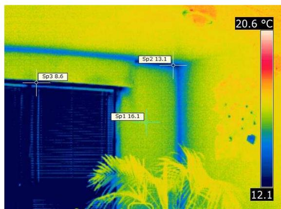
Cette prise de vue de l'intérieur d'une salle de séjour (appartement côté nord) avec coffre de volet roulant en intérieur montre les ponts thermiques en angle (Sp2) ainsi que l'entrée d'air froid par les grilles de ventilation sous le coffre de volet roulant (Sp3).
